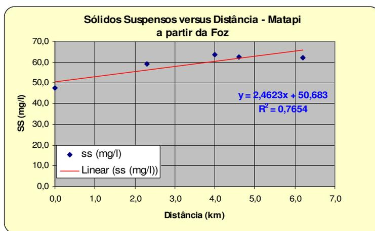
Figura-14a: Variação espacial longitudinal média da concentração de SS no Rio Matapi. Observa-se que na média há um comportamento de diminuição concentração em direção a foz do rio. A análise de regressão que gerou o modelo linear resultou num coeficiente de ajuste  $R^2 = 0,7654$ .
