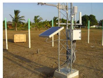
Estação Agrometeorológica Automática instalada em Macapá.
