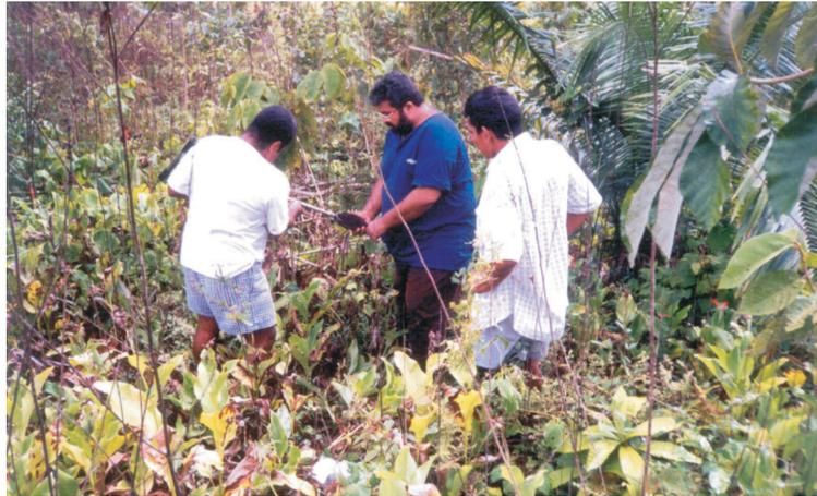
**Figura 12** - Coleta de solo realizada com trado até a profundidade de 20 cm, numa propriedade do igarapé Maicá.
