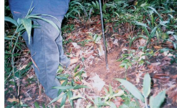
**Figura 37** - Tradagem ou coleta propriamente dita do solo para análise.
