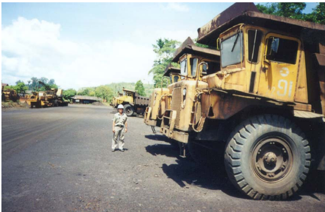
Figura 5: Caminhões com capacidade de transporte de até 35 toneladas de minério que operaram na lavra do minério de manganês nas últimas três décadas (Dezembro de 1999).
