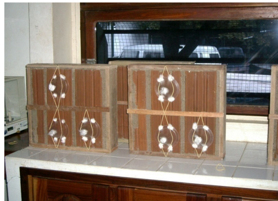
Figura 11. Painel de alvenaria sem reboco
